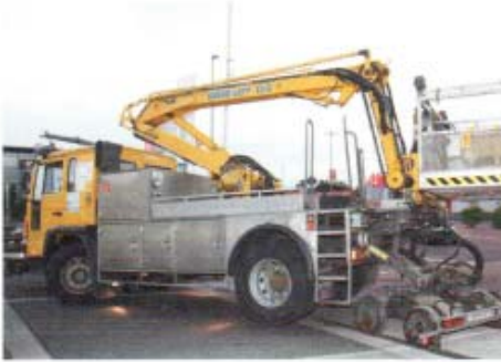
Exaktes Rangieren: Zum Aufgleisen müssen die Stahlräder ziemlich genau über die Schienen manövriert werden.
