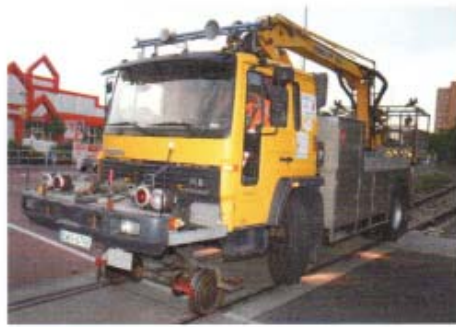
Exaktes Rangieren: Zum Aufgleisen müssen die Stahlräder ziemlich genau über die Schienen manövriert werden.
