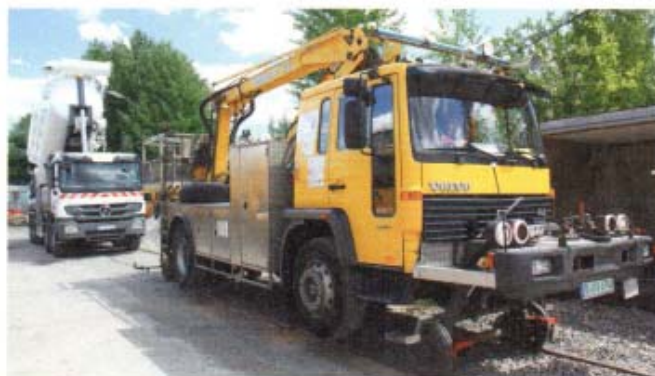
Besondere Technik: Die bahntauglichen Lastwagen und ihre Technik werden vor jedem Einsatz gründlich inspiziert.
