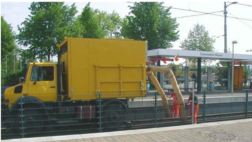
Unimog U1650 für Gleisreini- gungsarbeiten (bei DB / Tram)
