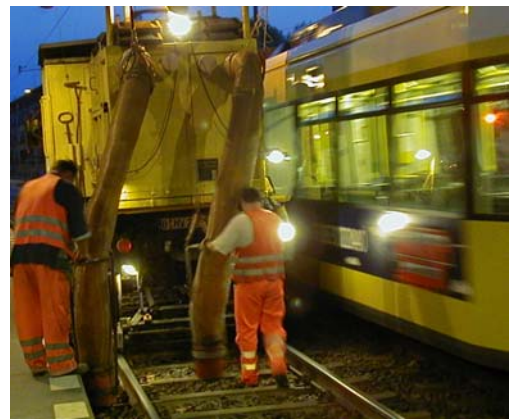
Unimog U1650 für Gleisreini- gungsarbeiten (bei DB / Tram)
