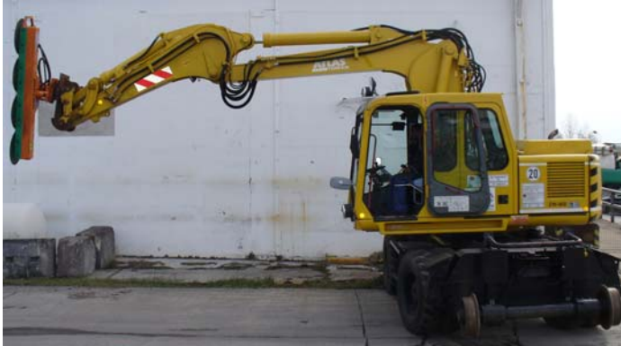
Zwei-Wege-Bagger mit 4-fach-Säge
