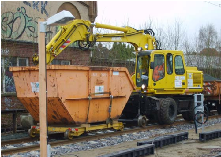
Zweiwegebagger Atlas 1604-ZW mit Baggeranbaugerät „tubecube TC1“
