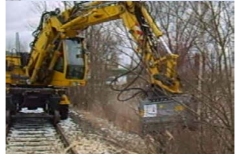
Zweiwegebagger mit Forstmulcher FAE Video unter: http://youtu.be/ezvwX5bjhA
